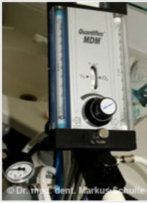
Apparecchio per la somministrazione di protossido di azoto con rapporto variabile protossido di azoto/ossigeno
